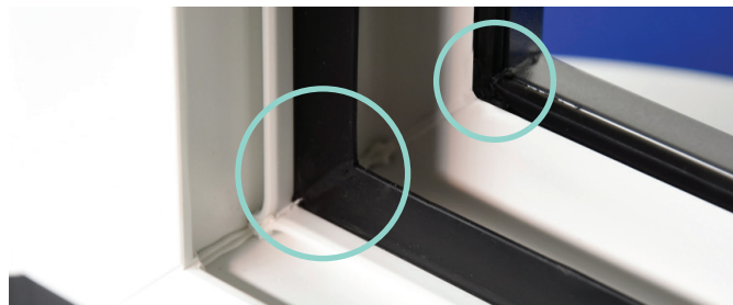
Fig. 2: Alle dichtingen of rubbers worden samen met het pvc-profiel geëxtrudeerd. Bij het samenstellen van de profielen tot een raam worden de rubbers mee gelast. Resultaat: perfecte wind- en waterdichtheid!
